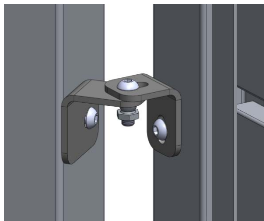
Obr. 5 Systém k nastavení úhlu mezi panely oplocení
